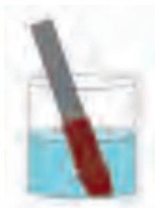
Lámina de cinc, en disolución de sulfato de cobre (II)
